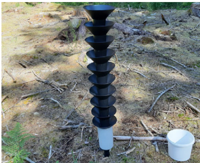
Auf dem Foto ist eine Borkenkäferfalle zu sehen – eine sog. Trichterfalle, die zur Überwachung der Borkenkäferpopulation eingesetzt wird. Foto: Paul Sailer
